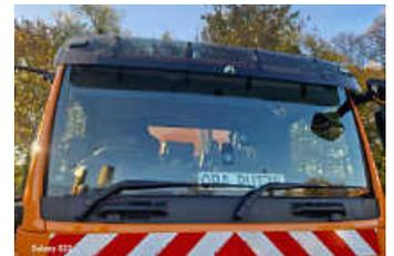
Die Smartphone-Kamera an der Frontschieber der Kehrmaschine überprüft den Straßenbelag auf Schäden. Foto: Stadt Öhringen
