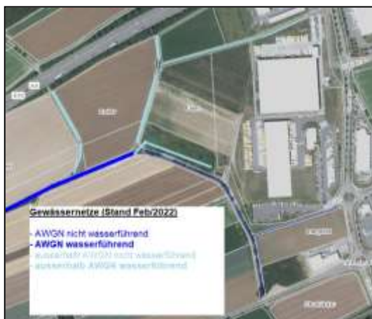
Abb.2: Wasserführung der Gewässer im Vorhabenbereich Wammesfeld Mitte Februar 2022.
